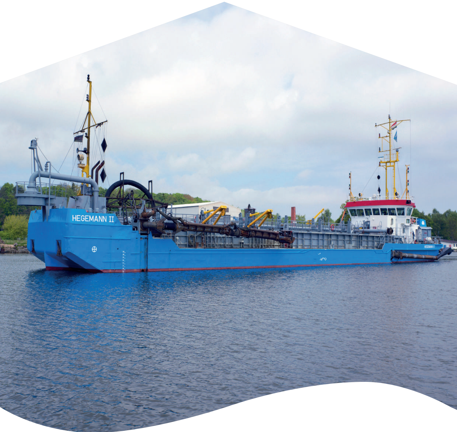
LADERAUMSAUGBAGGER | TRAILING SUCTION HOPPER DREDGER HEGEMANN II
